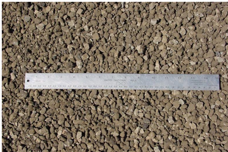
รูปที่ 4 วัสดุแอสฟัลต์คอนกรีตเดิมที่ผ่านการย่อยและคัดขนาดแล้ว
