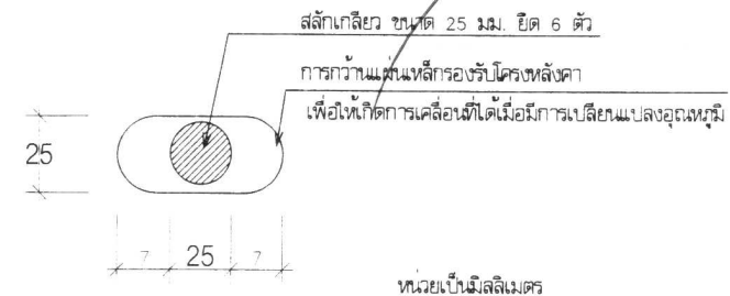
แบบขยายการก๊วแน่นเหล็กกับโครงคาน
